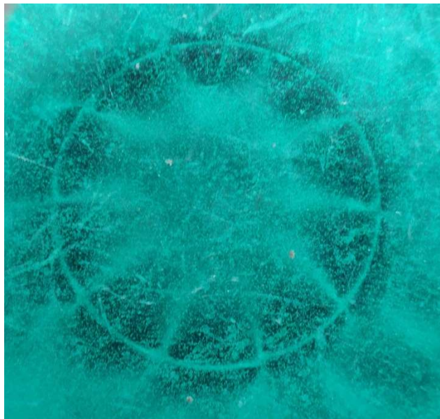
图 3-1 磁显纸下的转子磁钢
