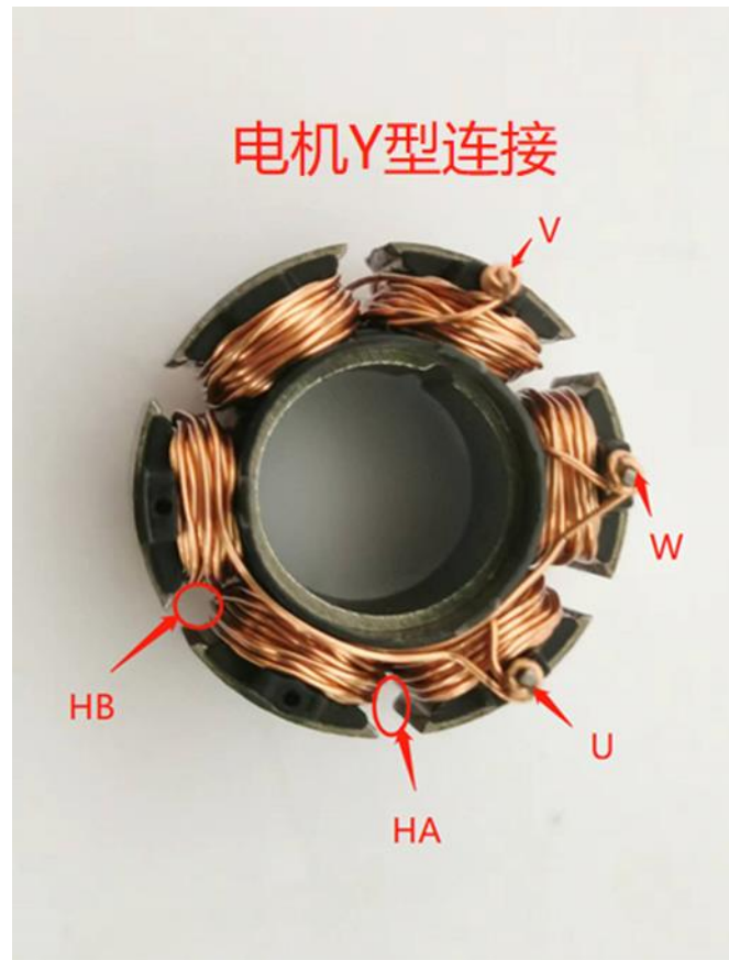
图 2-1 电机 UVW 出线与霍尔放置位置
