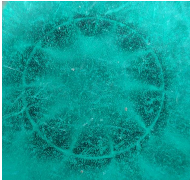
图 3-1 磁显纸下的转子磁钢
